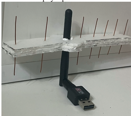
Рисунок 1 – Модель насадки на USB Wi-Fi адаптер
