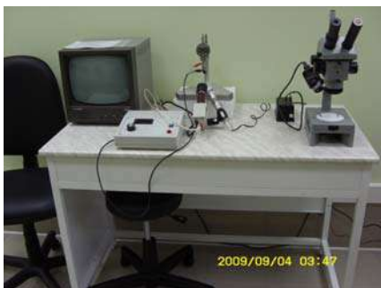
Установка формирования игл для зондовых микроскопов «GPI-100A»
