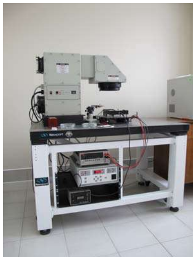
Установка для исследования характеристик солнечных элементов Oriol I-V
