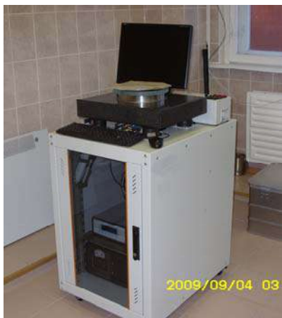
Вакуумный зондовый микроскоп с системой магнетронного напыления
