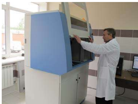
Рентгеновский дифрактометр ARL X'tra
